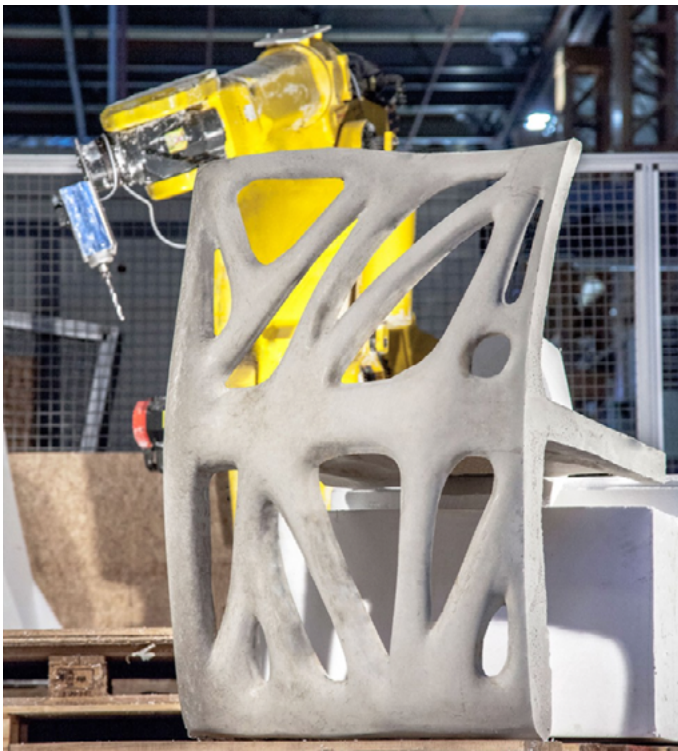
5. Prototype gemaakt met behulp van robotgefreesde techniek. Foto: Studiorap.
