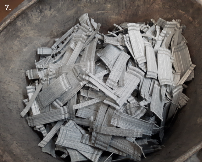
7. In het beton is 35 kg/m³ staalvezelwapening toegevoegd.
