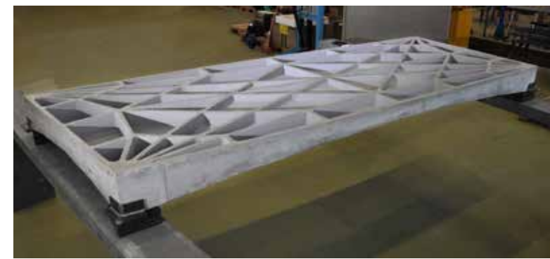
5. Funicular floor system, 1:1 prototype voor NEST HiLo. Foto: Block Research Group, ETH Zurich.
