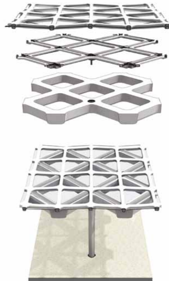
Figuur: Opbouw van de dakconstructie van de betonnen overkapping van het Ministerie van Defensie in Den Haag.
